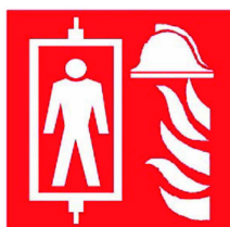
图 B.17 消防电梯标识图例
